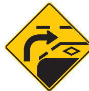
Бордюрна смуга перехрестя попереду є резервною смугою
